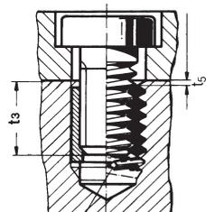
Avant de tarauder, assurez-vous qu'il y a un chanfrein à 90°C et qu'il n'y a pas de bavures. Diamètre extérieur du **chanfrein** = **D<sub>HC</sub> + 0.1 mm**.
