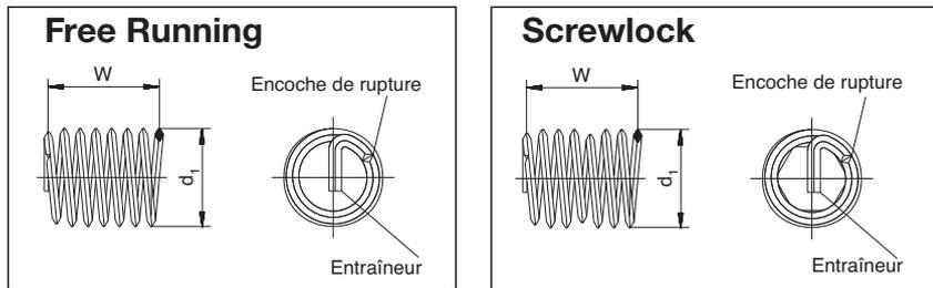
Les cotes de contrôle des filets rapportés avant montage sont W et d<sub>1</sub>.
