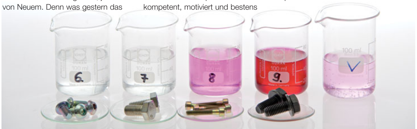
Laborprüfung zur Bestimmung von Cr 6+ in Korrosionsschutzschichten
