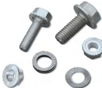
Sicherungselemente zur Verhinderung der Relativbewegung zwischen den Verbindungselementen (Verriegelungszähne, Sicherungsrippen, mikroverkapselte Klebstoffe). Festlegung: Mind. 80% der Vorspannkraft soll erhalten bleiben.
