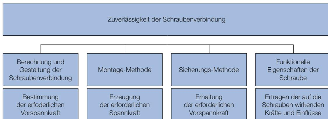
Aus Merkblatt 302\*): Eine gut ausgelegte und kontrolliert angezogene Schraubverbindung benötigt in der Regel keine zusätzliche Schraubensicherung!
