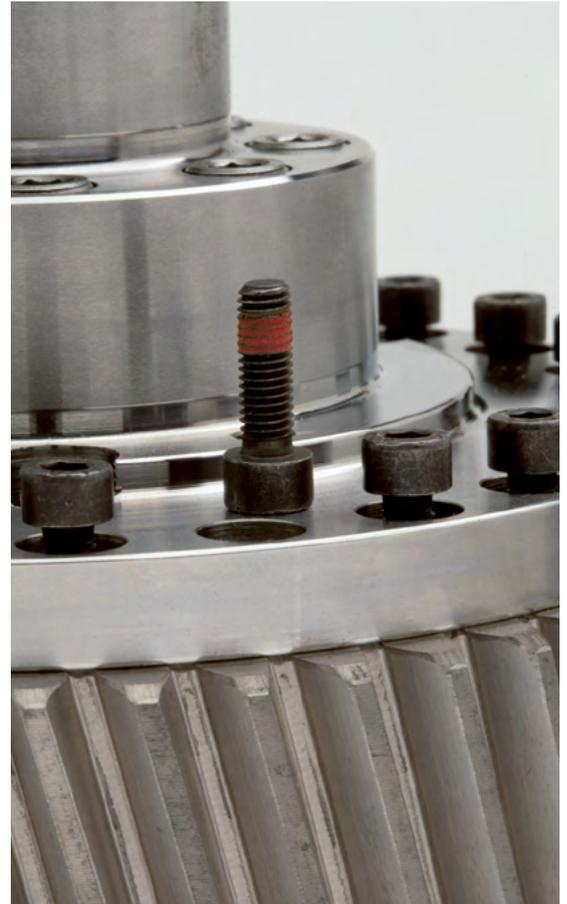
Zusätzlich können die chemischen Gewindegewissungen eine dichtende Funktion bieten. Hier sollte darauf geachtet werden, dass die Beschichtung rundum ausgeführt wird und die Zusatzanforderungen definiert werden.
