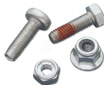
Sicherungselemente verhindern das vollständige Auseinanderfallen der Verbindung. Das Prinzip beruht meist auf einer Erhöhung der Reibung bzw. Klemmung im Gewinde oder Unterkopf. Weniger als 80% der Vorspannkraft bleibt erhalten.
