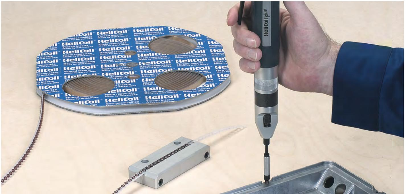
Einbau des HELICOIL® Plus
