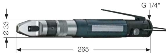
Für die schnelle Verarbeitung von HELICOIL® Plus Gewindeeinsätzen M 4 bis M 12 mit entsprechender HELICOIL® Plus Einbauspindel
