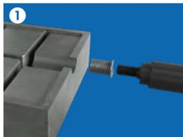
1 Stahlform, HELICOIL® Cast und automatische Spindelvorrichtung
