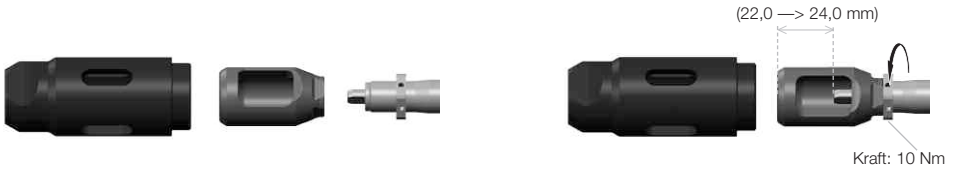
Abbildung 3 - Gewindedornaufnahme und Mundstückhalter für Blindnietschraube oder einer Nietkraft >22 kN (M8 & M10)
