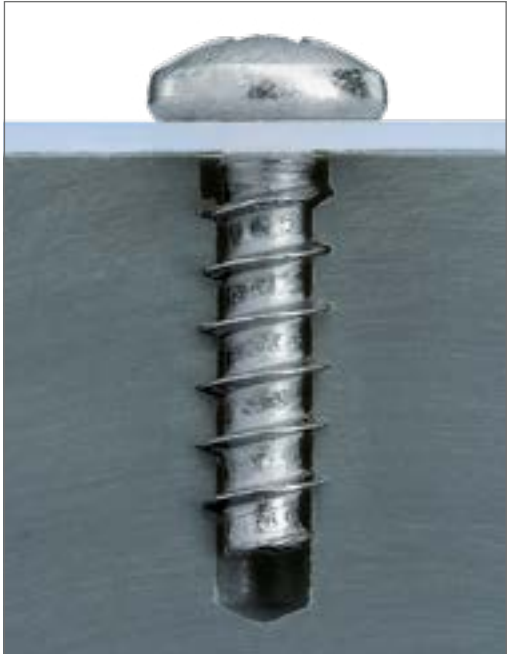
Bild 8.1 Gewindeformende Schraube für Kunststoffe
