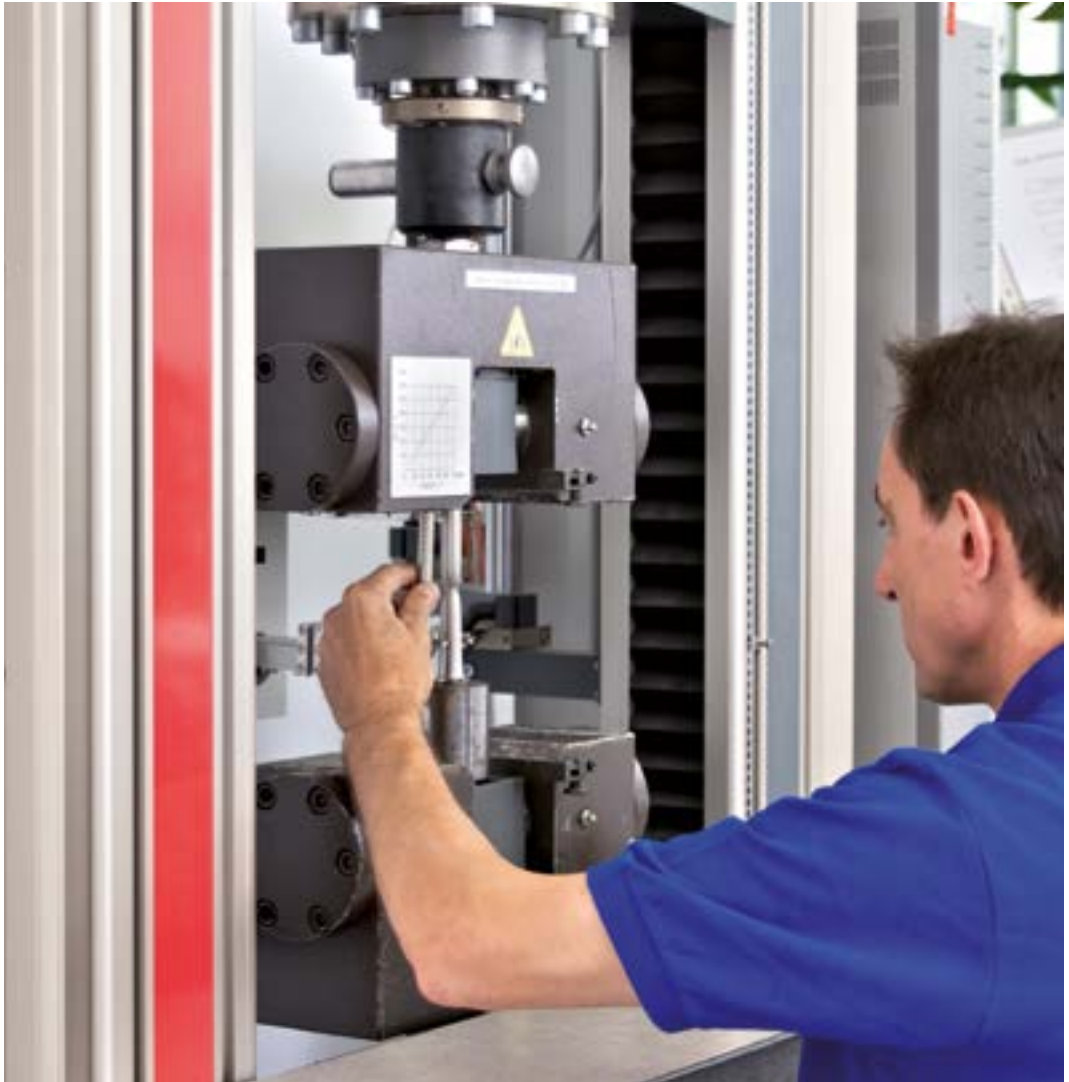
Bild 3.9 Zugversuch im akkreditierten Labor in Bielefeld
