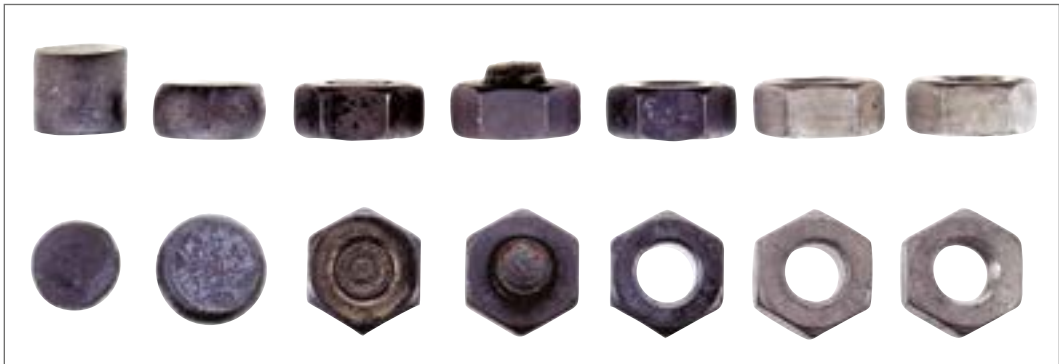
Bild 5.4 Umformstufen einer Sechskantmutter
