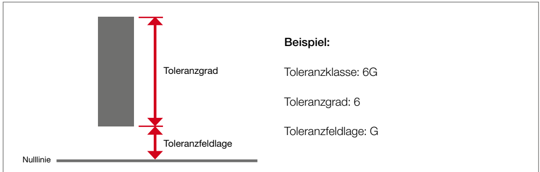
Bild 6.4 Toleranzsystem nach DIN ISO 965-1
